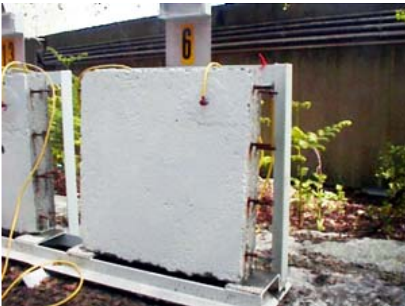
Bild 6: Spritzverzinkte Betonprobe mit organischer Beschichtung im Außenprüffeld der Grillo-Werke AG
