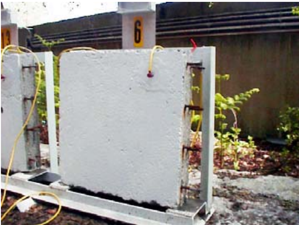
Figure 6: Spécimen de béton revêtu de zinc projeté avec en plus un top-coat organique
